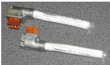
Реперные датчики температуры 0°C и 100°C;
