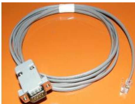
Кабель для подключения блока МБУ-010 к сетевому адаптеру.
