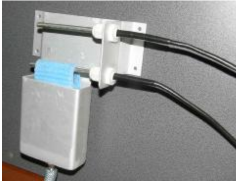
Внутренняя ванночка с держателем «сухого» и «влажного» термометров;
