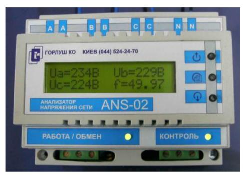
Анализатор напряжения сети ANS-02 (в дальнейшем по тексту именуемый "прибор") предназначен для автоматического защитного отключения контролируемого им электрооборудования (например, вентиляторы сушильной камеры) в случае отклонения напряжения питающей сети за пределы установленного допуска. Защитное отключение оборудования осуществляется с помощью контактов встроенного в прибор электромагнитного реле.
