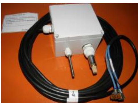
Узел камерного контроля УКК-01. Длина кабеля составляет величину от 4 до 35 метров. В комплект включается один или два узла контроля.
