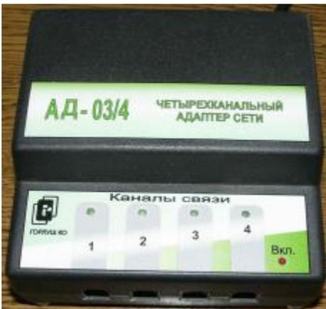
4-х канальный сетевой адаптер, подключается к порту RS-232 компьютера.
