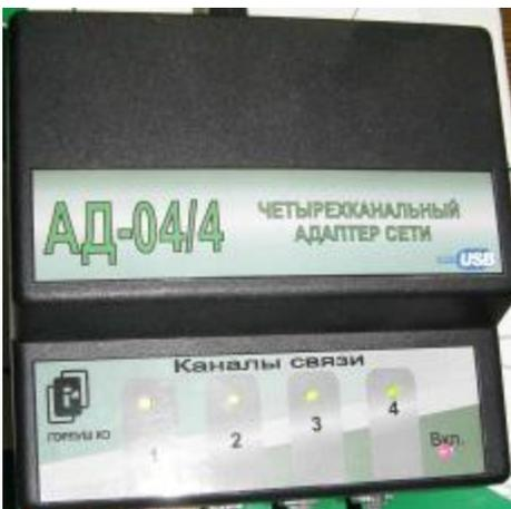
4-х канальный сетевой адаптер, подключается к USB порту компьютера.
