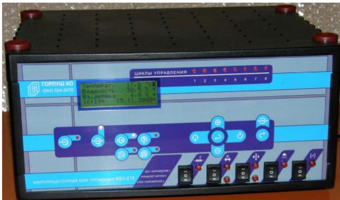
**Автоматика МБУ-010 обеспечивает** контроль и поддержание заданных параметров: температуры и влажности в соответствии с заданной программой и выдачу сигналов на исполнительные механизмы.
