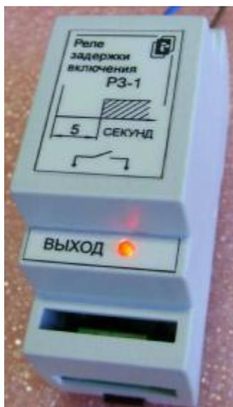
Реле выполняет следующую функцию: при подаче напряжения питания через заданное время появляется выходной сигнал, исчезающий после снятия напряжения питания.
