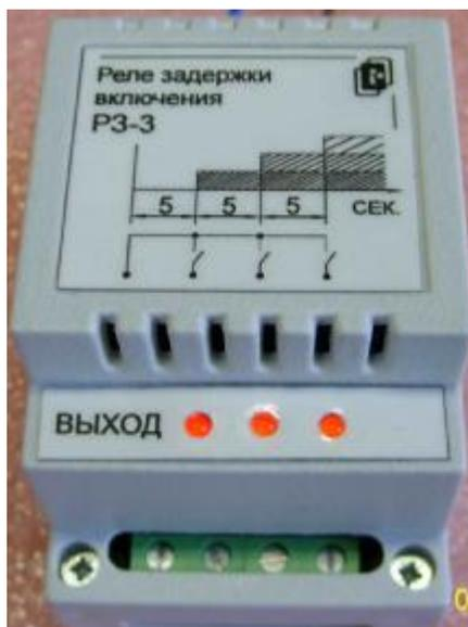
Реле выполняет следующую функцию: при подаче напряжения питания через заданное время появляется сигнал на выходе 1, еще через заданное время появляется сигнал на выходе 2 и еще через заданное время появляется сигнал на выходе 3, которые исчезают после снятия напряжения питания.
